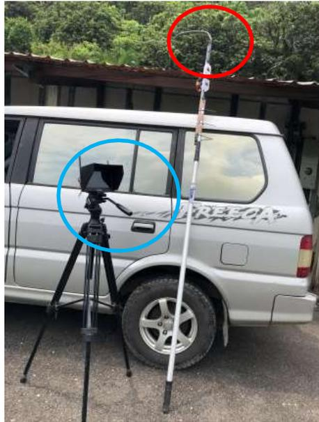
圖 3、檢視巢內的可攜式內視鏡。紅圈處為影像傳輸端，藍圈處為影像接收端。
