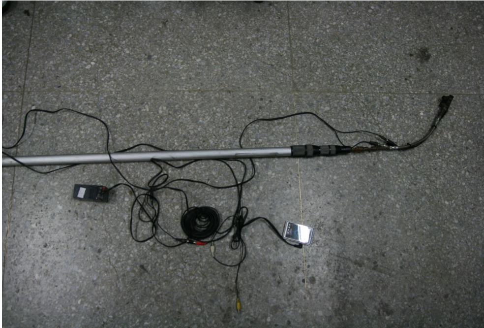
圖一. 以針孔攝影機及微型監視器組合而成之自製探巢器
