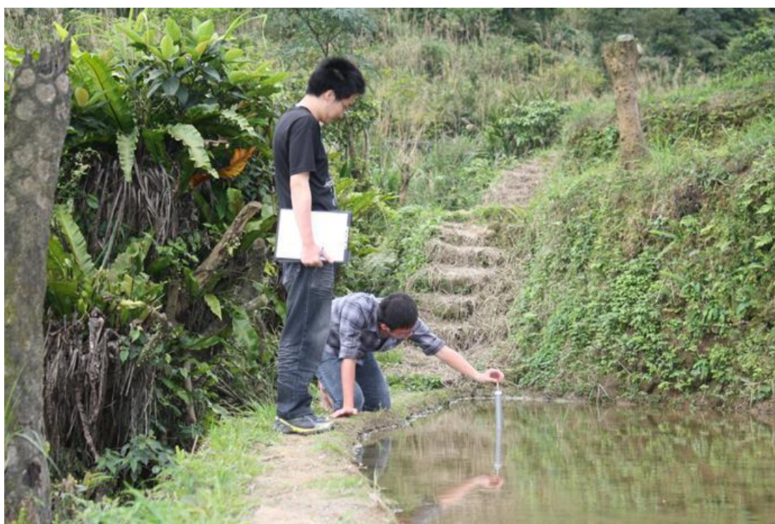
附錄 A-圖 6 水梯田減水深試驗安裝浮球式水尺情形
