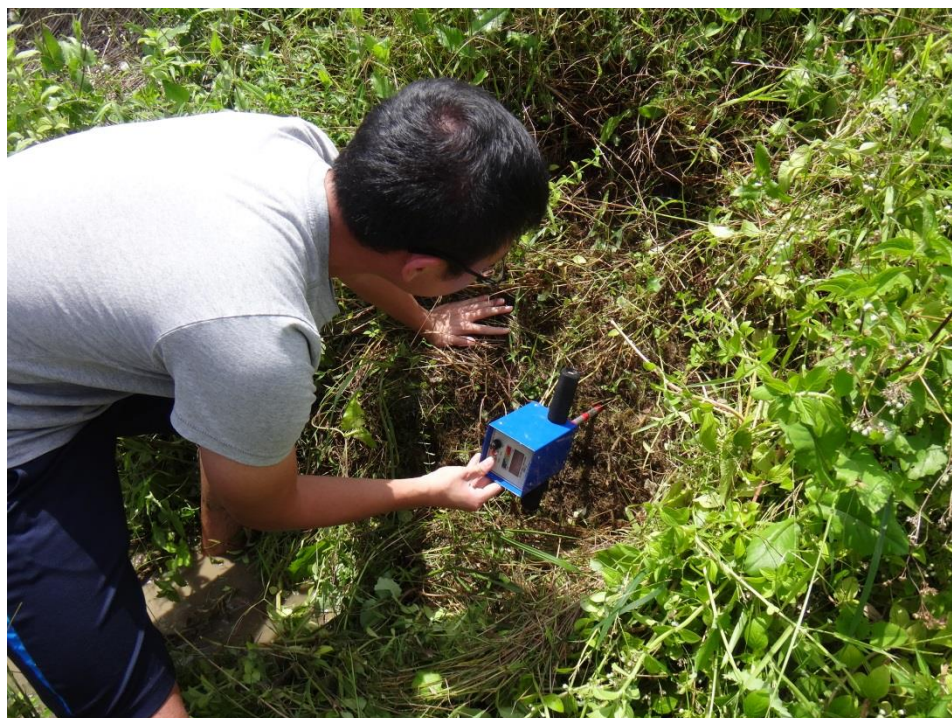
圖 3.16 土壤水分飽和度量測
