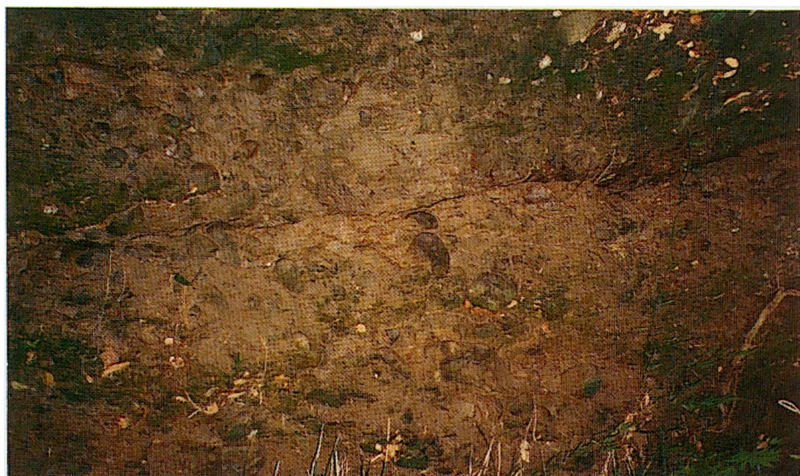
3 膠結良好的礫岩有明顯的裂縫，為滲水的地方
