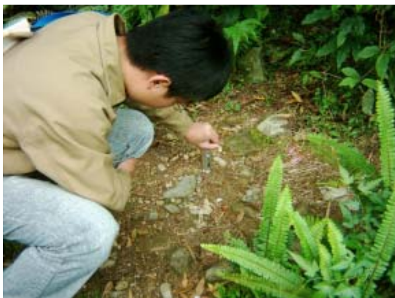
圖 4.2.9 位於桶后林道 14K 大礁溪山登山口測量土壤硬度
