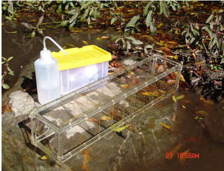
圖3 以壓克力附著板記錄附著藻類的變化
