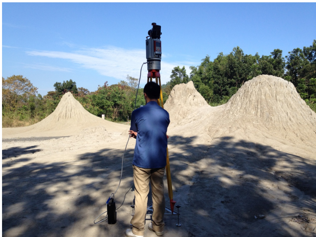
圖 6 地面型 3D 雷射掃描測量系統於烏山頂現場實際施測情形
