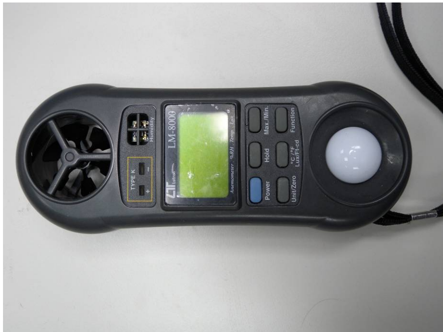
圖二、台製四合一環境測試器，Lutron 型號:LM-8000。
