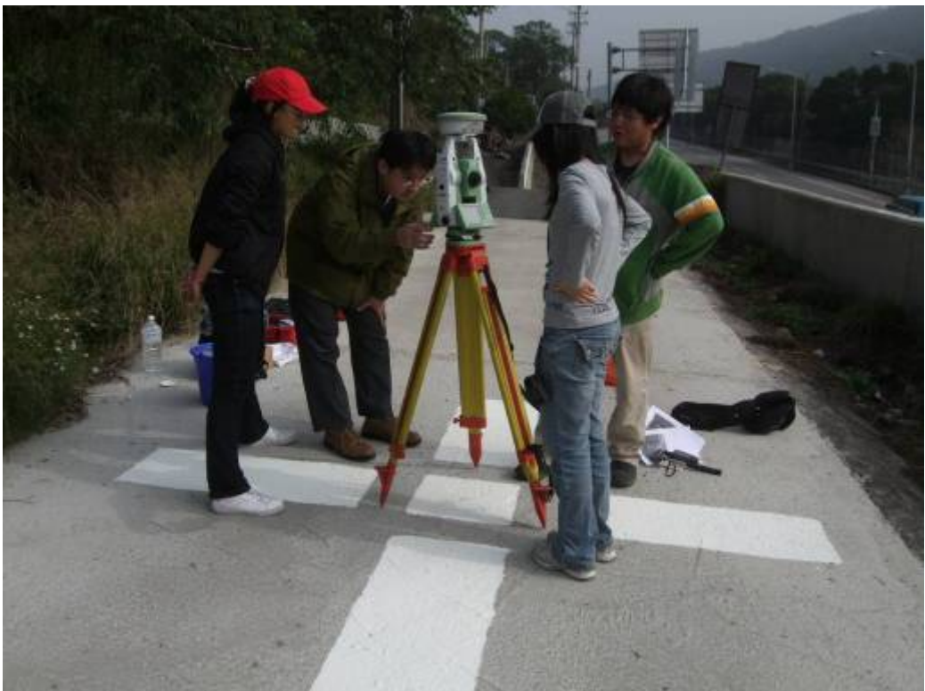
圖 6.19 空標控制點測量
