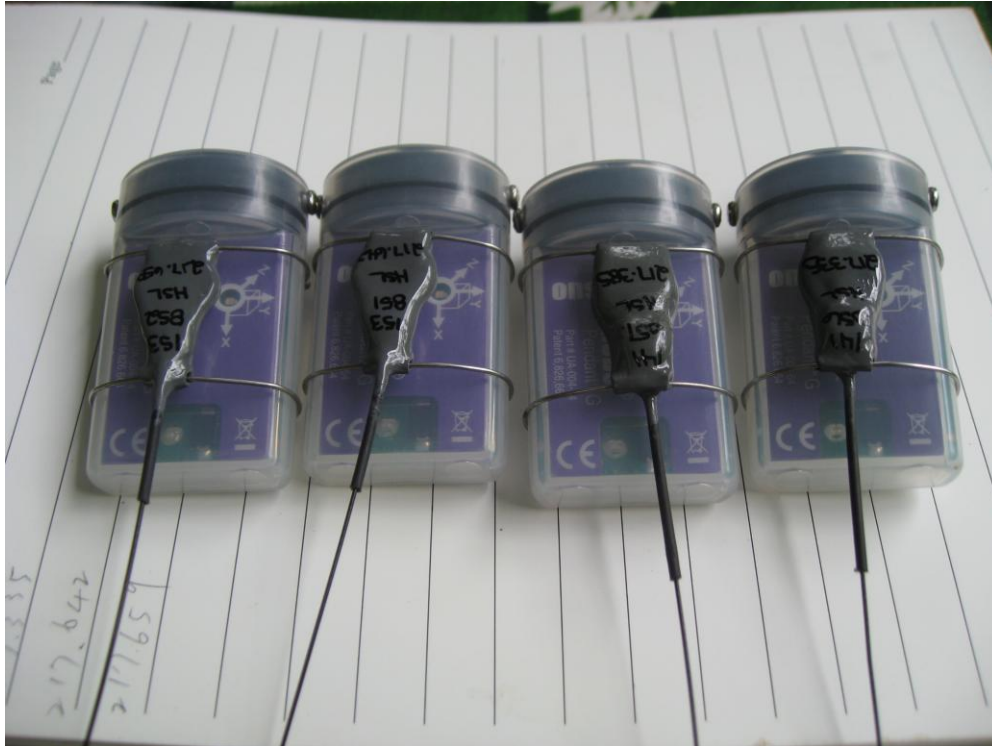
圖四、偵測食蛇龜活動的加速記錄器 (acceleration data logger, UA-004-64, Onset Computer Corporation, Massachusetts, USA) 和小型的無線電發射器 (3g PD-2 transmitter, Holohit Systems Ltd., Ontario, Canada)。
