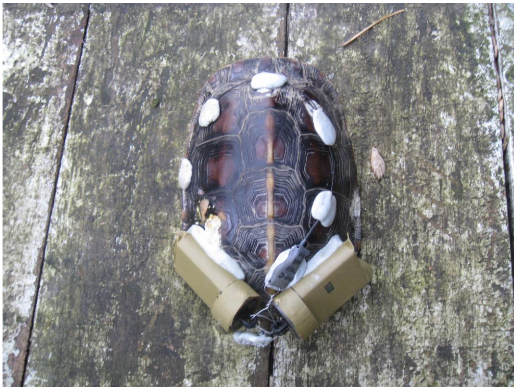
圖五、背覆了加速記錄器、溫度光度記錄器 (Temperature/illuminance data logger, UA-002-64)、和小型無線電發射器的食蛇龜。
