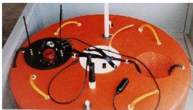
圖二十六、High Tech, Inc 公司生產的無線電聲納浮標系統。 (來源： http://www.hightechincusa.com/taab.html )
