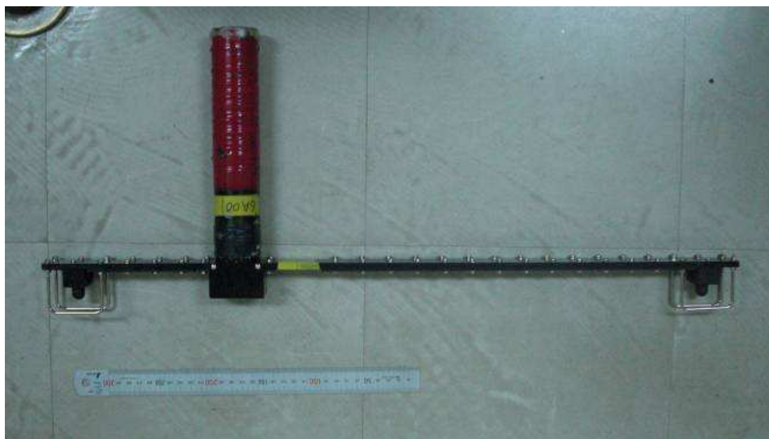
圖二、固定式水下聲音資料紀錄器(A-tag)，紅色部份為長效性電池盒，橫桿兩端連接著兩個水下麥克風。
