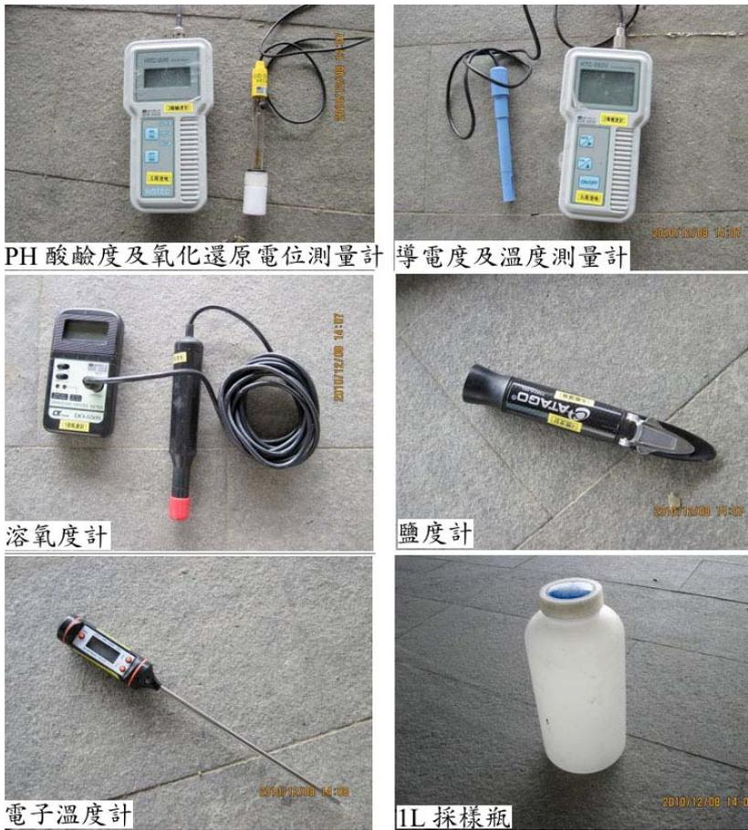
圖 3.2.2-2 水質檢測儀器和工具
