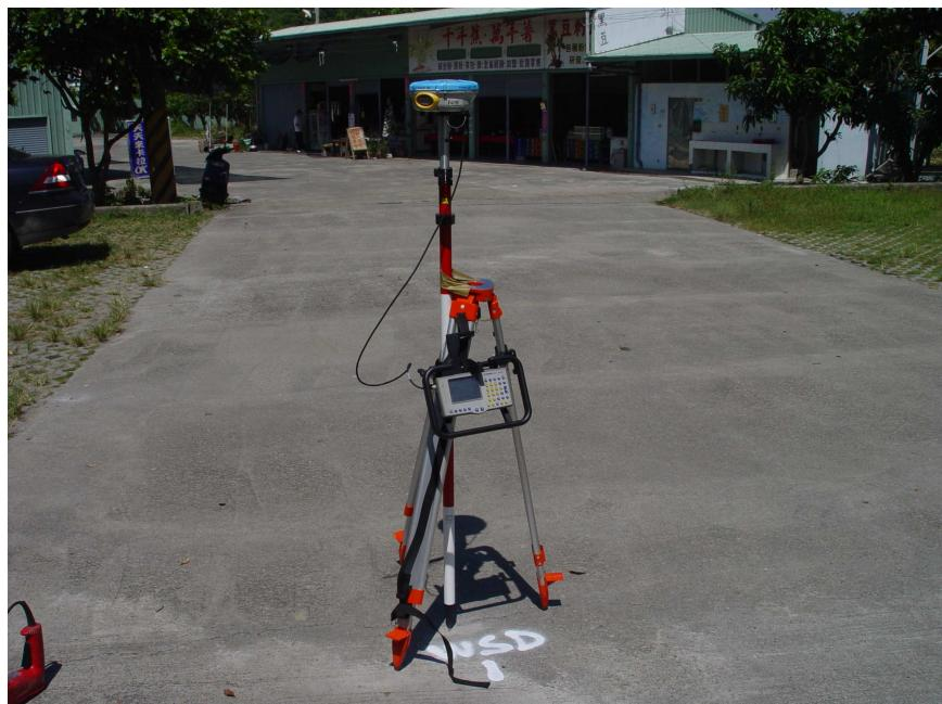
圖 18 烏山頂泥火山區域測量基準點引測作業
