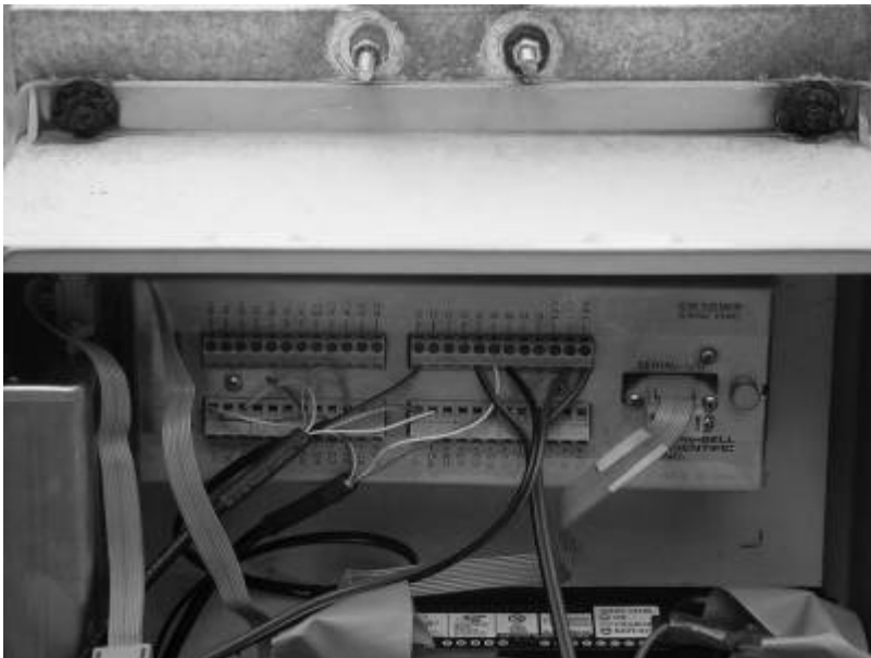
圖 2.13 儀器箱內部（中央為資料收集器、下方為電池、左方為資料記錄器）
