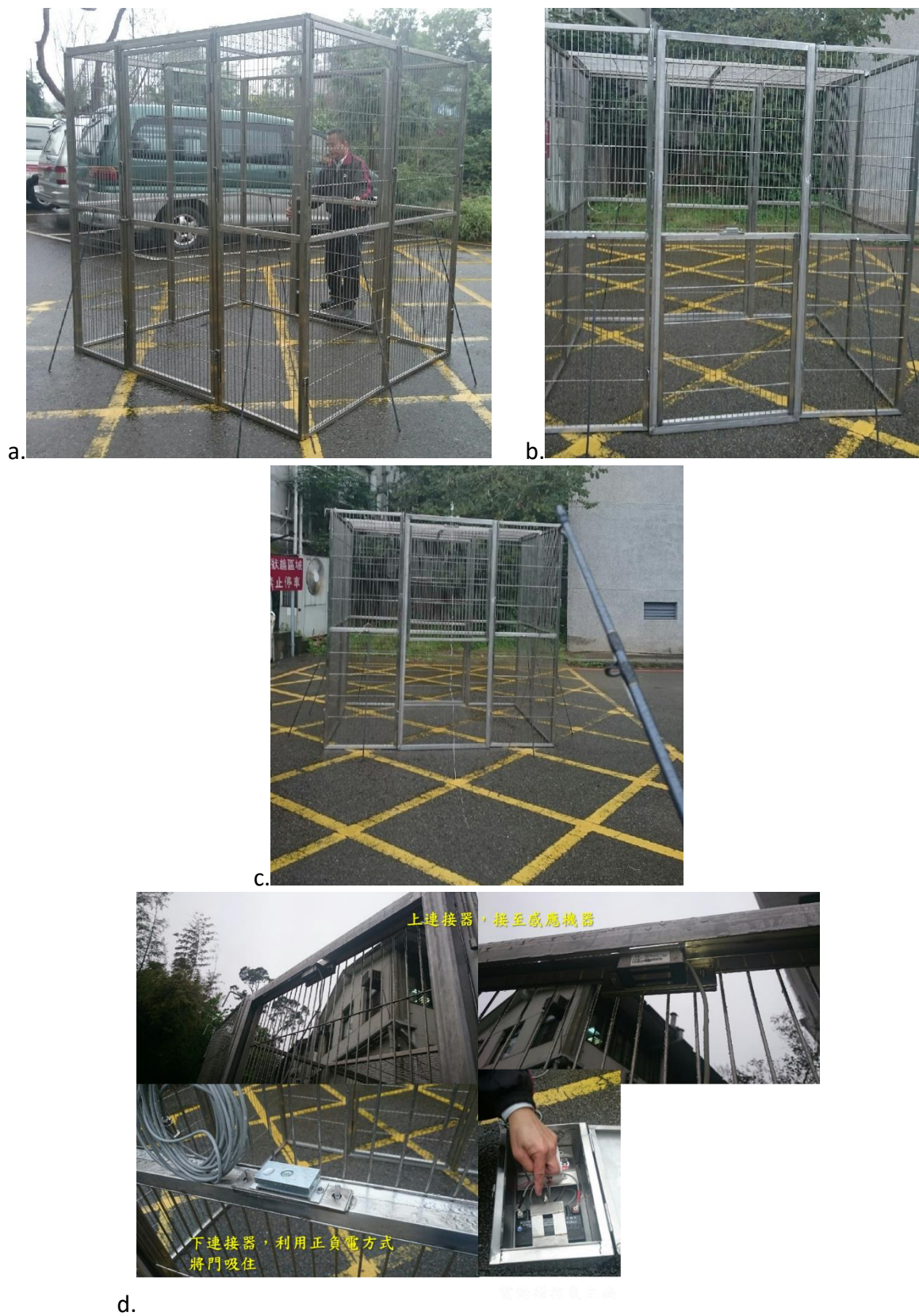
圖十八、大型捕捉籠完成圖 a.後門 b.前門 c.手動遙控 d.電動遙控。
