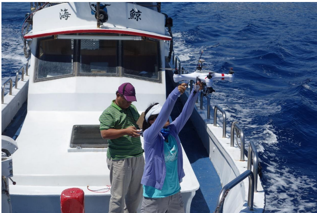
圖 3、四軸飛行器施放方式（綠衣者持遙控器，紫衣者持飛行器）。
