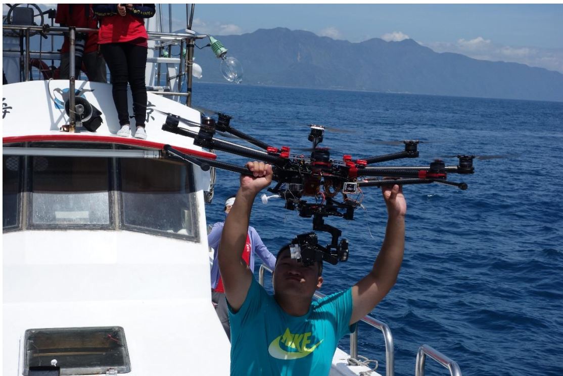
圖 5、八軸飛行器一樣可以手持起飛。
