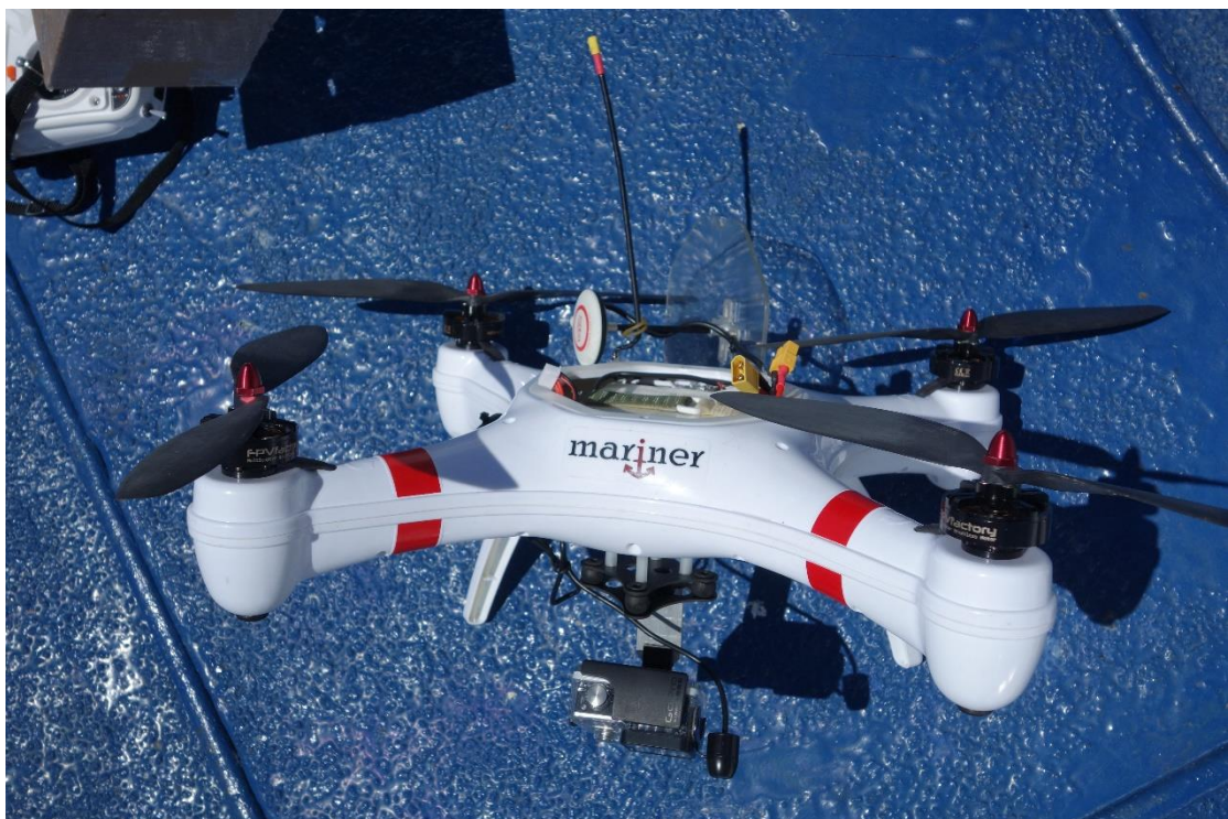
圖 2、本次無人飛行載具調查所使用之四軸飛行器（下方為 GoPro® 攝影機）。
