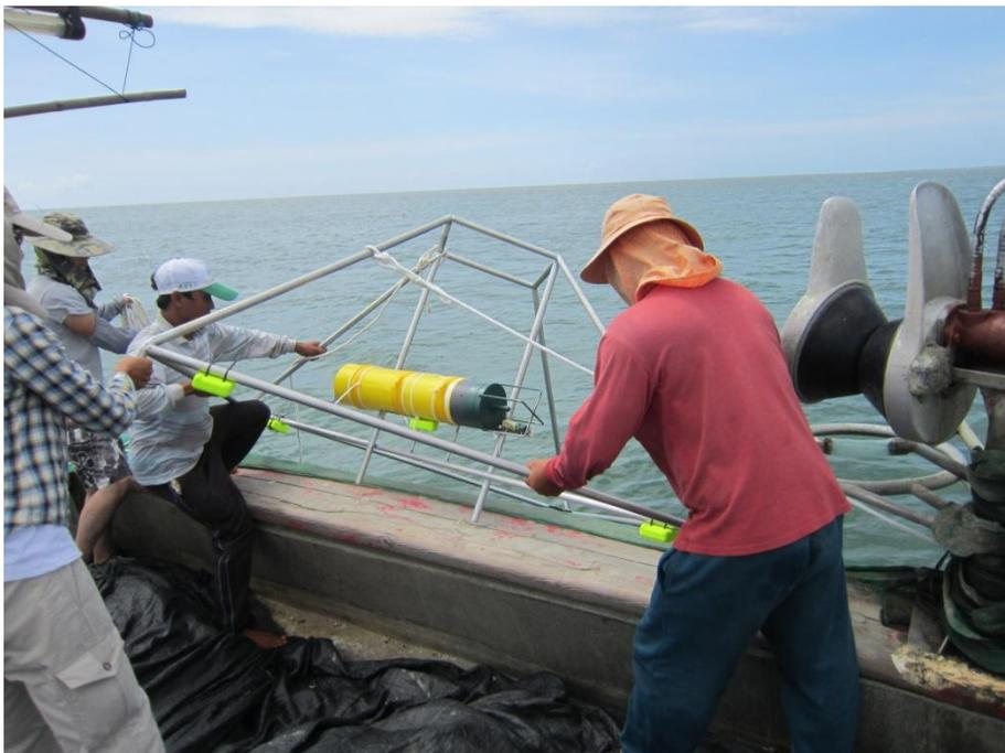
圖四、本計畫所採用的 SM2M 海洋錄音機固定在儀器支架後，固定在海床上之前的工作照片
