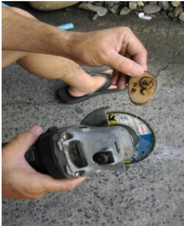
照片 3-1-8：烙印後使用砂輪機打磨。
