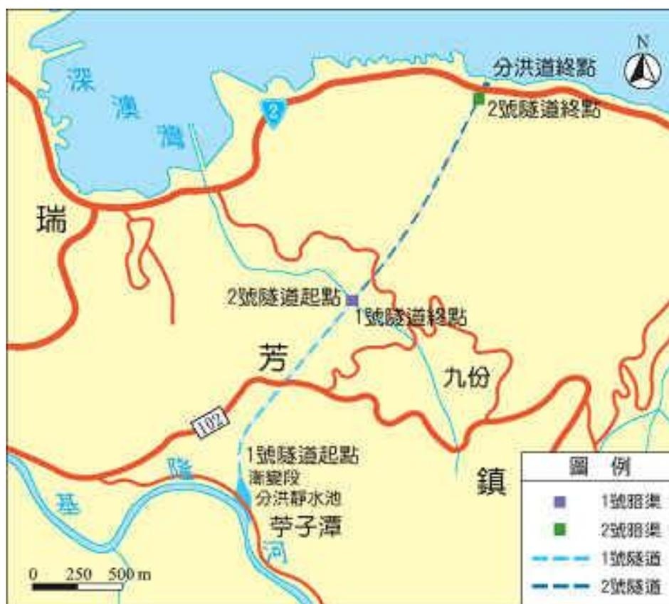
員山子分洪於平時豪大雨期間，當攔河堰前水位達 EL62.4 公尺時，本局(第十河川局)即派員進駐員山子分洪管理中心，全天候監控分洪設施及水位雨量資料，至於颱風警報期間則配合淡水河流域防洪指揮中心二級開設，由本局副局長率隊進駐管理中心，負責監控及分洪操作。員山子分洪進水口結構佈置情形
