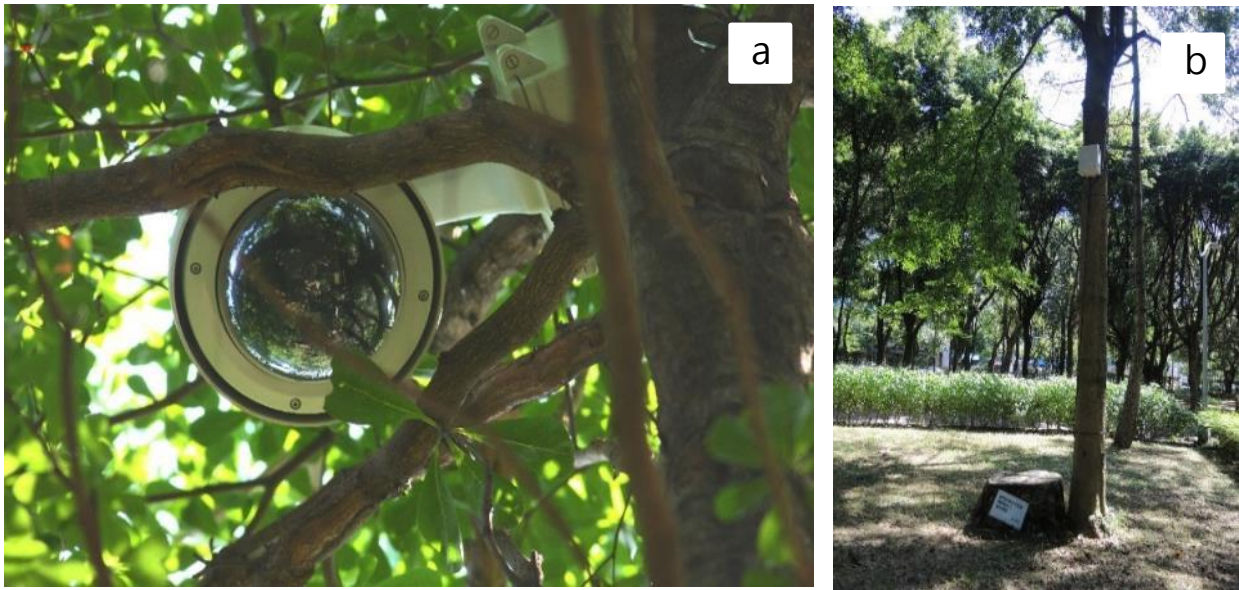
圖 2 於巢樹旁架設之全天候監視攝影機，包括 a. ECL- HDS20 Full- -HD 攝影鏡頭。b. 移動式電源及無線網路傳輸基地台
