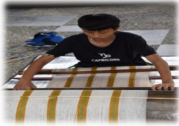
整經完成後套在迴線桶(Qongu)，整理整經好之後即可開始織布(tminun)，耆老耐心的教導學生如何套線材及織布。織步過程需注意的方法與技巧：綁腰帶、起點固定、邊線處理、打棒、提綜砵儲線夾(大)、穿線、打棒、收尾等編織的方法，織出的織品才會漂亮美觀！學生分享傳統地機編織的心得，異口同聲都說還是地機編織較佳，織品較牢固、寬度比織帶機寬，且編織者與地機(Qongu)融為一體的感覺，學生們覺得很感動，體會並瞭解泰雅織女們在織布的過程，~原~來是那麼地辛苦！
