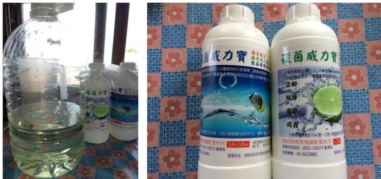
▲二氧化氯分為 A、B 劑，使用方法是依據水體大小調配 A、B 劑比例，以 1 公噸水體為例，需要使用 18 公升的水搭配 A、B 劑各 1 公升的劑量；調配方法是先將 A 劑均勻溶於水後再加入 B 劑，密封靜置半小時。
