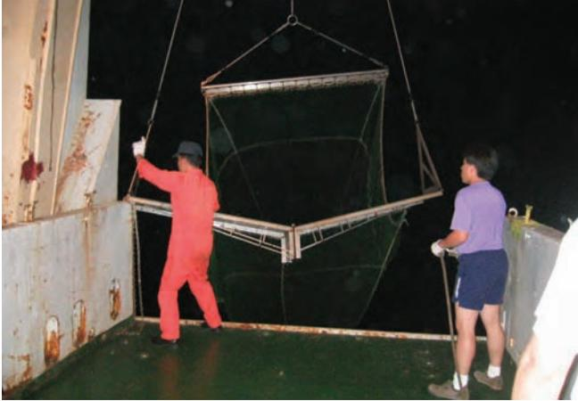
◀ 正由船尾支架緩慢投放下海的中層拖網，主要設計目的為採集中層的深海生物，藉由連接船上的鋼索長度以及角度，並配合船行速度來控制網子的採集深度
