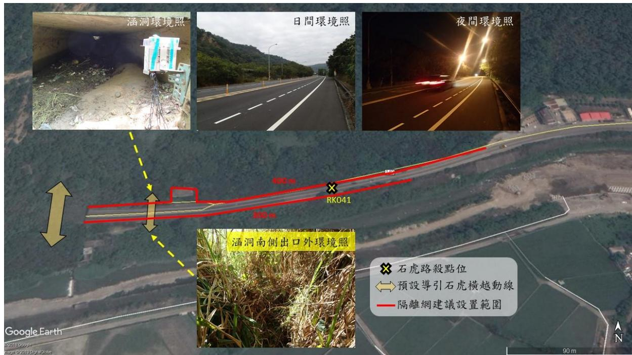
圖 26、火炎山隧道東側出口段改善建議圖。紅線為防護網建議設置範圍。黃色粗箭頭為預設導引石虎穿越馬路動線。
