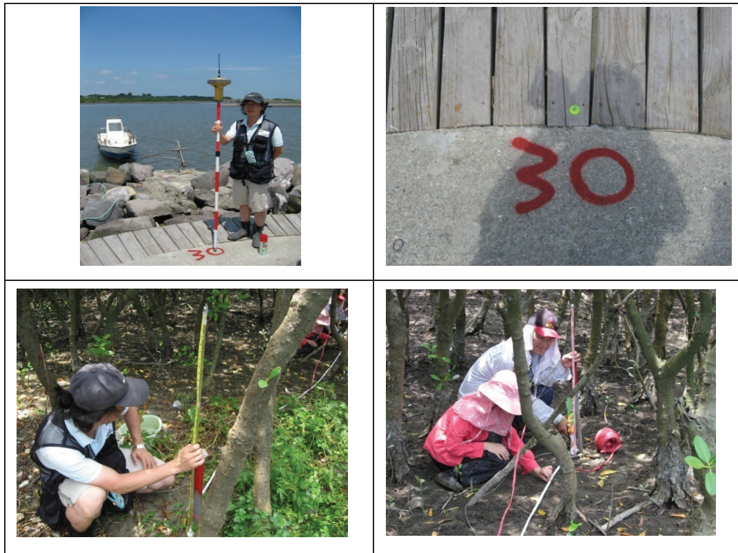
圖 5.7 連通管測量儀操作情形
