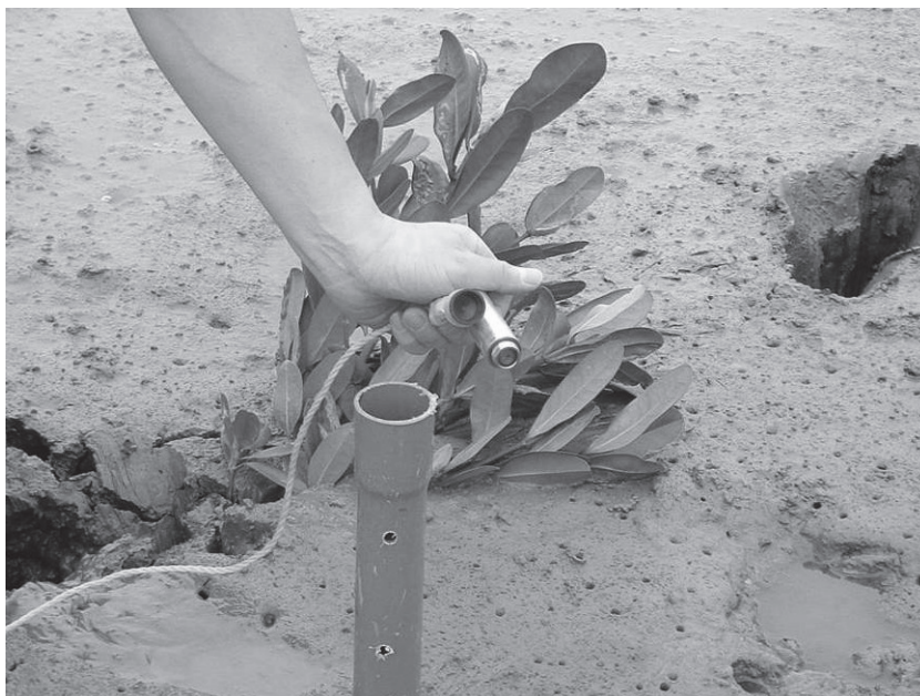
圖 5.8 自記水位計裝置示意圖
