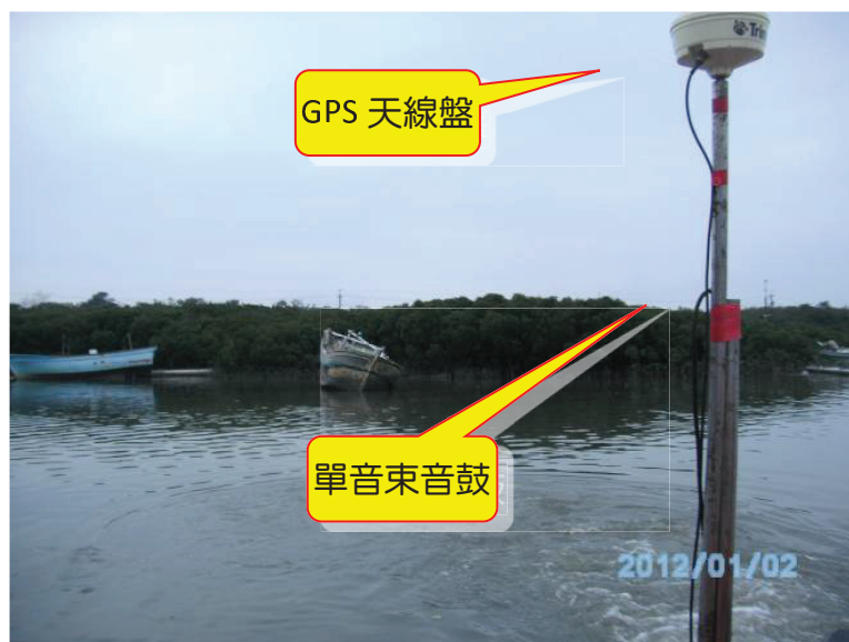
圖 5.5 單音束 GPS 天線盤、音鼓架設圖
