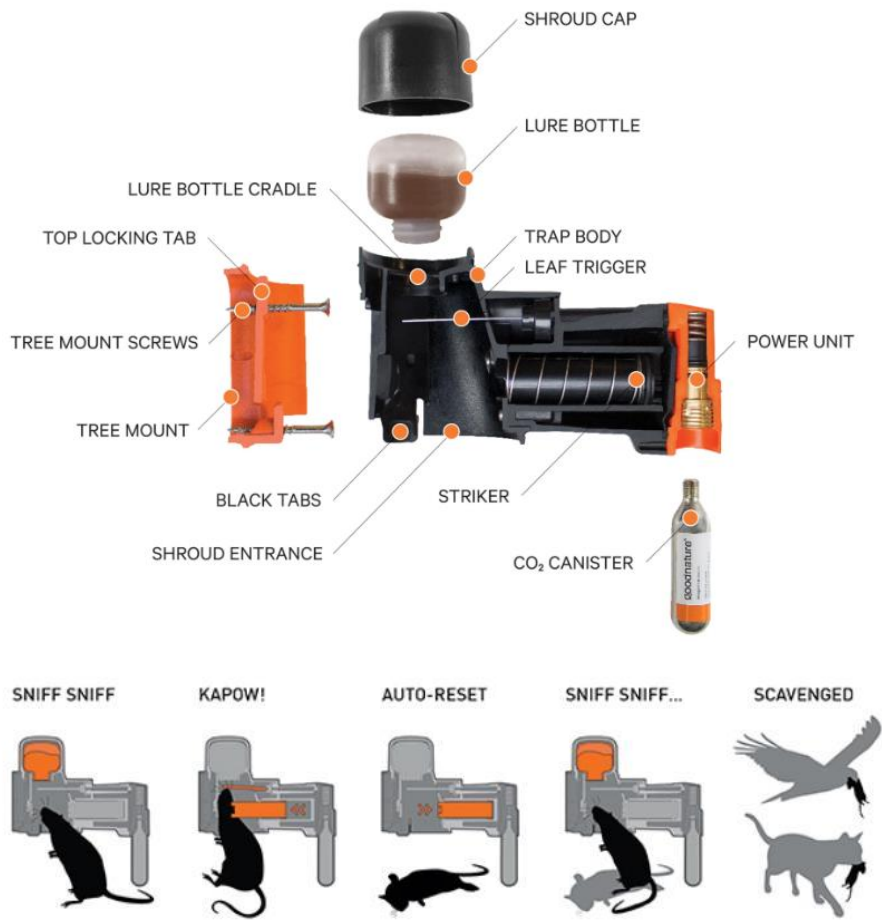
圖 3. GoodNature A24 無毒自動滅鼠器裝置圖與運作示意圖
