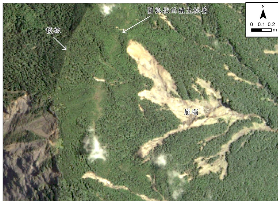
圖 22、張力裂隙導致地表植生呈現圓弧狀的枯萎示意圖
