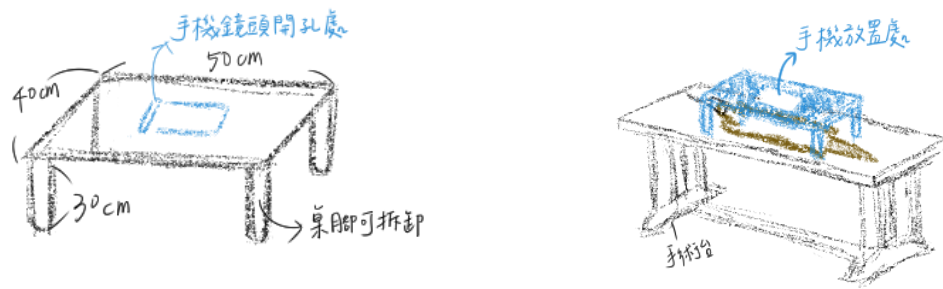
(圖一) 穿山甲體態拍攝腳架示意圖。
