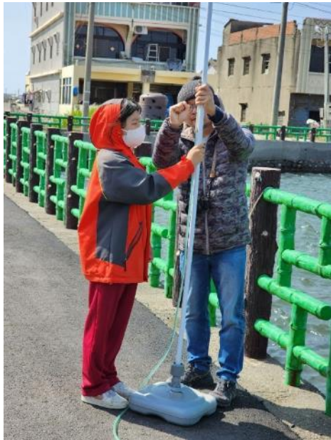
▲使用水平管測量成龍村的地勢高程
