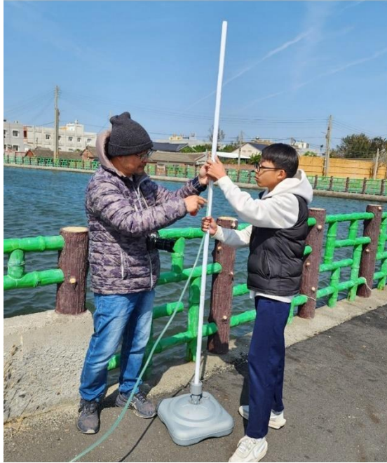
▲利用水平儀測量村子地勢的變化
