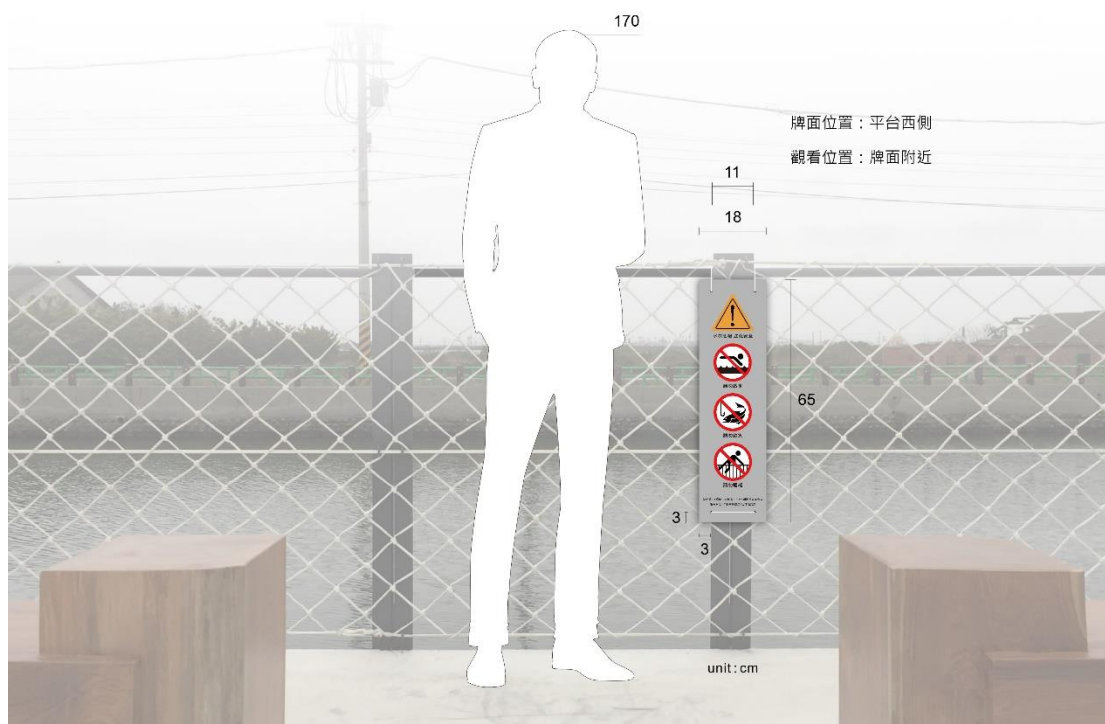
▲安全告示牌 - 安裝位置&模擬圖
