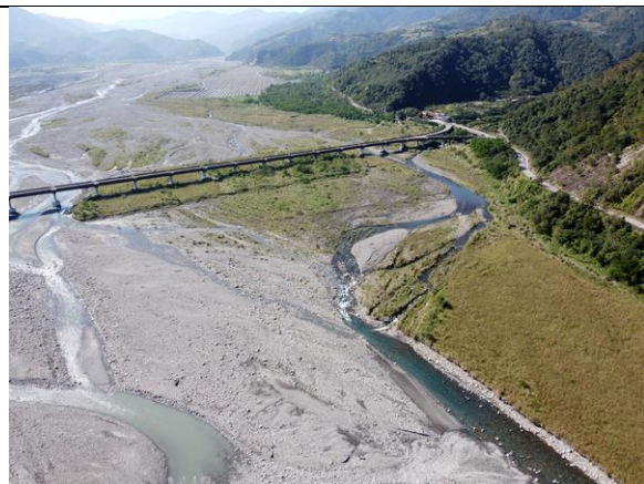
非大雨後的豐水期間 ( 12/22 )，從下游側往匯流口可明顯見到流路得繞過泰雅大橋橋基的橫向高灘地，入流距離拉長，一直到疏濬邊界形成跌水瀨區後，又沿著疏濬邊界形成平流。
