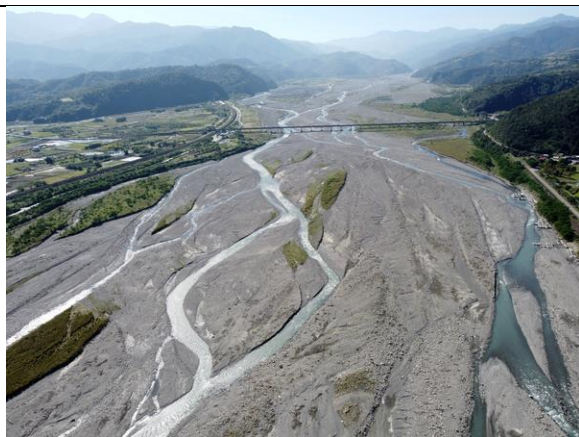
非大雨後的豐水期間 ( 12/22 )，從下游側往匯流口可明顯見到流路得繞過泰雅大橋橋基的橫向高灘地，入流距離拉長，一直到疏濬邊界形成跌水瀨區後，又沿著疏濬邊界形成平流。
