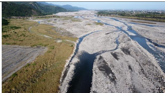
泰雅大橋上游靠近破礮溪的辦流，因為疏濬邊界的高程落差，以及未疏濬之高灘地許可種植，高灘地上的流路在非大雨後的豐水期間 ( 12/22 )，係以表層伏流方式慢慢湧出，在疏濬邊界附近沒有地表實質的連通。
