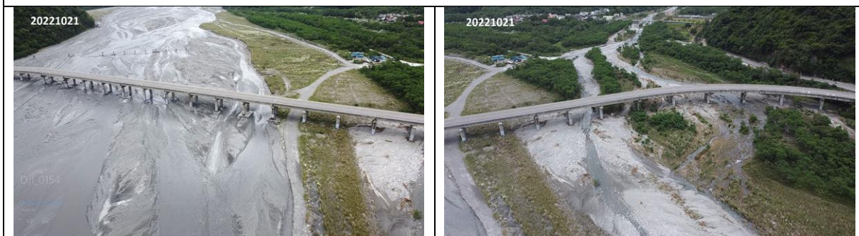
2022 年（左）1 月，疏濬邊緣加上施工便道形成的高灘地高差明顯存在。（右）5 月非豐水期間楓溪在高灘地上轉折前進，抵達匯流口水量逐漸下滲且失去坡度提供的動能而沒口。
