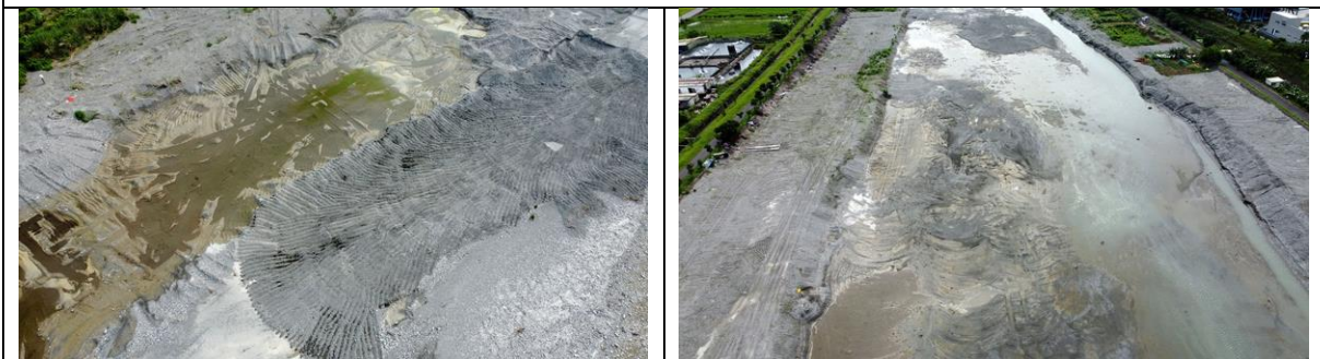
2021/08 疏濬前期可發現局部河段可能因種植需求，培厚高灘地使河道中有複式斷面，反而束縮了低頻率年洪水的通洪斷面。
