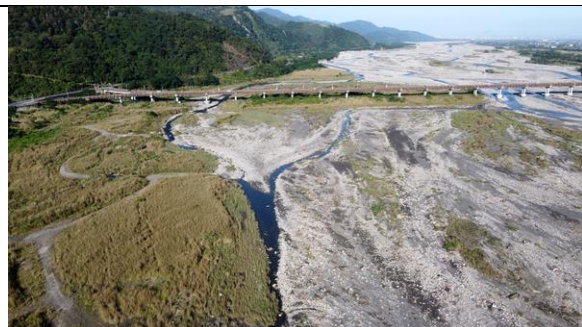
泰雅大橋上游靠近破礮溪的辦流，因為疏濬邊界的高程落差，以及未疏濬之高灘地許可種植，高灘地上的流路在非大雨後的豐水期間 ( 12/22 )，係以表層伏流方式慢慢湧出，在疏濬邊界附近沒有地表實質的連通。
