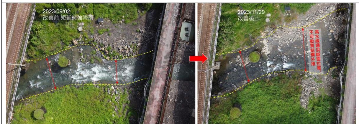
(左) 土石堆改善前對小型洪水的挑流。(右) 改善後小型洪水位的斷面擴大。將早年固床工外購料拆下的不可動河床質往外調，拉寬高水位時的通洪斷面，平時則創造緩流梯度
