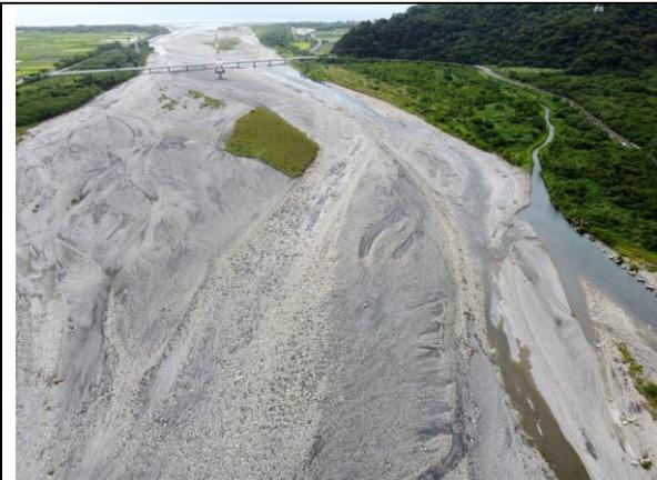
即使三幹線土堤沒有阻斷全斷面，但從 5/4 的空拍可發現，由於瓣狀河的流路間高程差很小，可能因為過去流路的集中，南北溪合流後的水流（左）在水量減少後，完全被引導到三幹線中（右）。
