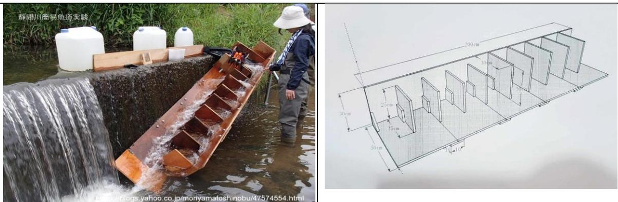
原訂仿 (左) 日本使用在多條溪流的簡易木製魚梯，架設於土堤，並已完成設計及相應的木料採購及木工預約 (右)。現先以塊石處理跌水，未來將視實際狀況機動進場。
