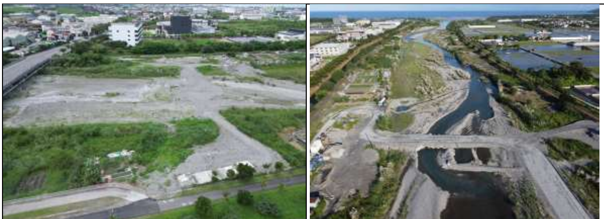
( 左 ) 龍德大橋下游高程未降而相對隆起的管制站。( 右 ) 管制站及過水路面在 12 月豐水期的樣子。
