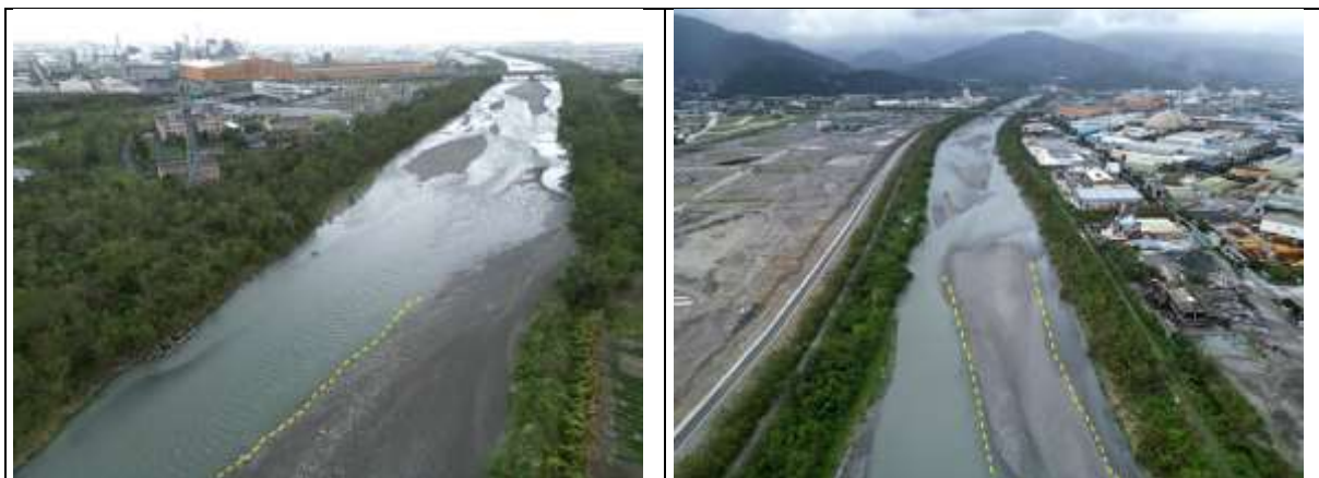
局部段落的直線痕跡仍可看出先前疏濬的灘槽直線結界，（左）鐵路橋下右岸於 8 月補救才降低高程的束流高灘，（右）龍德大橋上左右兩道取砂深溝的引導。
