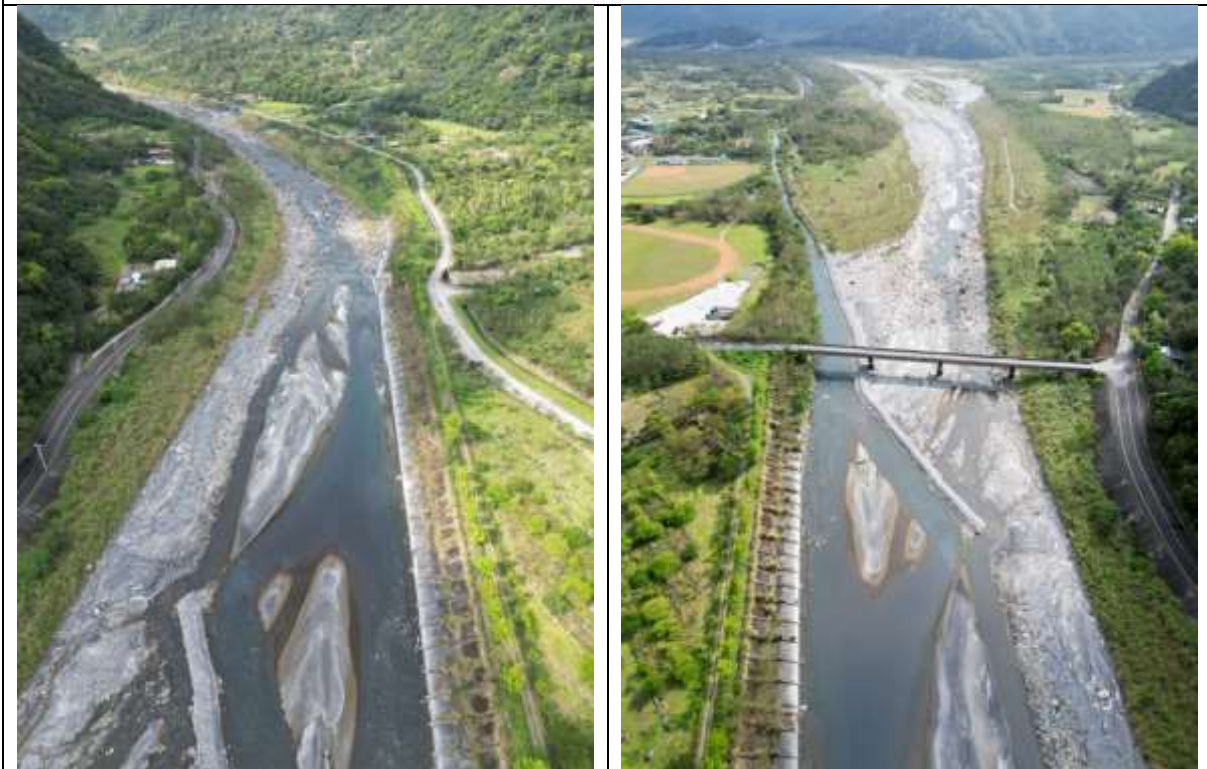
（左）一月圍堤時，明確留下缺口，（右）使北溪下游在二幹線導水路之外仍有連續水流。
