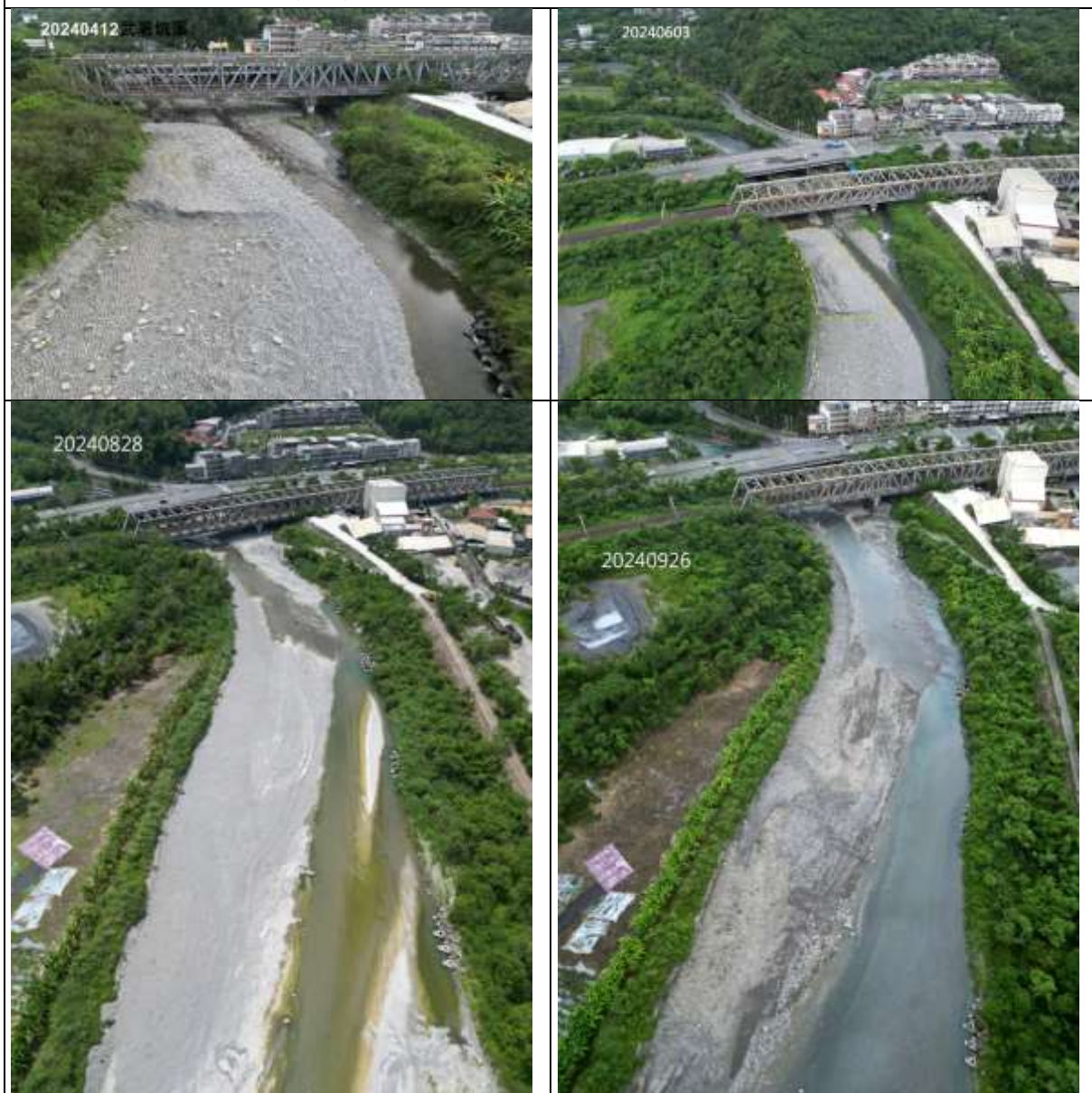
局部段落的直線痕跡仍可看出先前疏濬的灘槽直線結界，（左）鐵路橋下右岸於 8 月補救才降低高程的束流高灘，（右）龍德大橋上左右兩道取砂深溝的引導。
