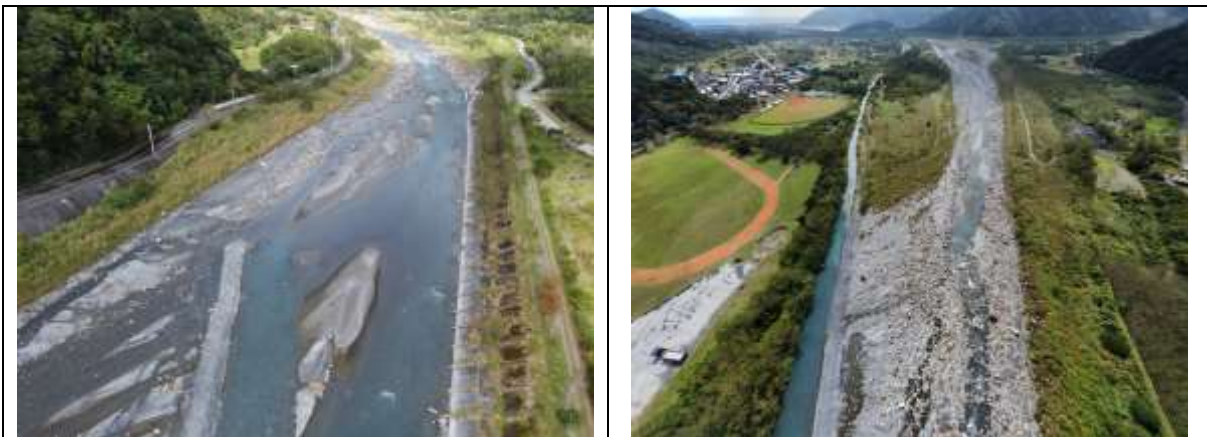
（左）一月圍堤時，明確留下缺口，（右）使北溪下游在二幹線導水路之外仍有連續水流。
